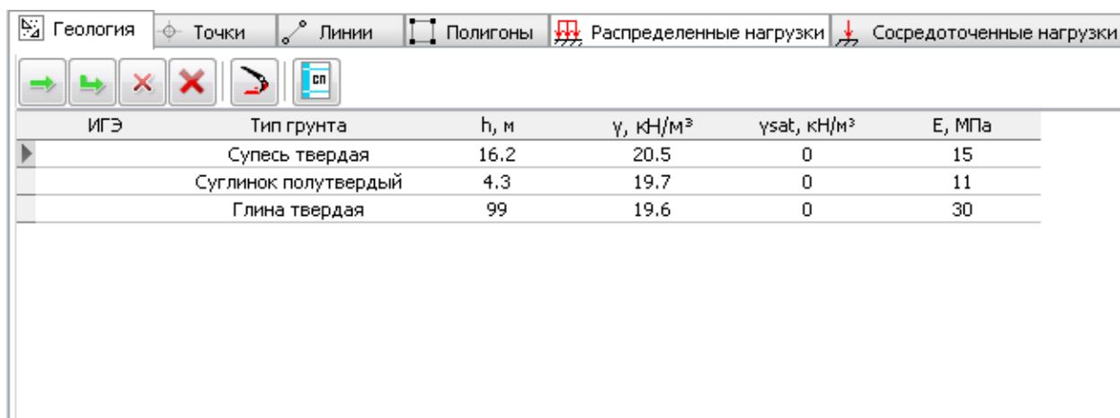
Примечание: удельный вес грунта в водонасыщенном состоянии можно не задавать, так как нет грунтовых вод.
